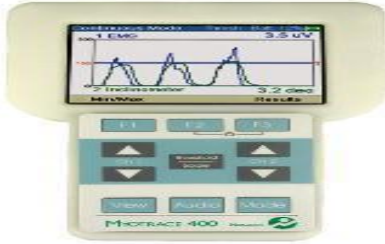
شكل ( ١ ) يوضح جهاز EMG المستخدم في مجال البحوث الرياضية .
